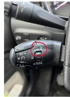
**30-Faites fonctionner l'essuie-glace arrière du véhicule.**
