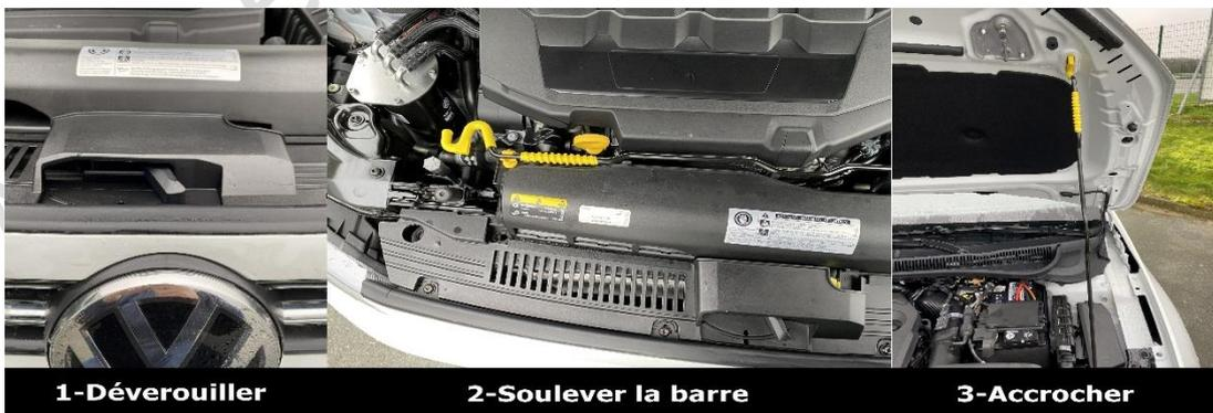
**Pour un capot s'ouvrant depuis l'avant du véhicule, quelle est l'utilité du dispositif de sécurité ?**
