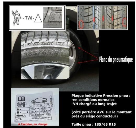
**26-Sur le flanc d'un pneumatique, désignez le repère du témoin d'usure de la bande de roulement.**
